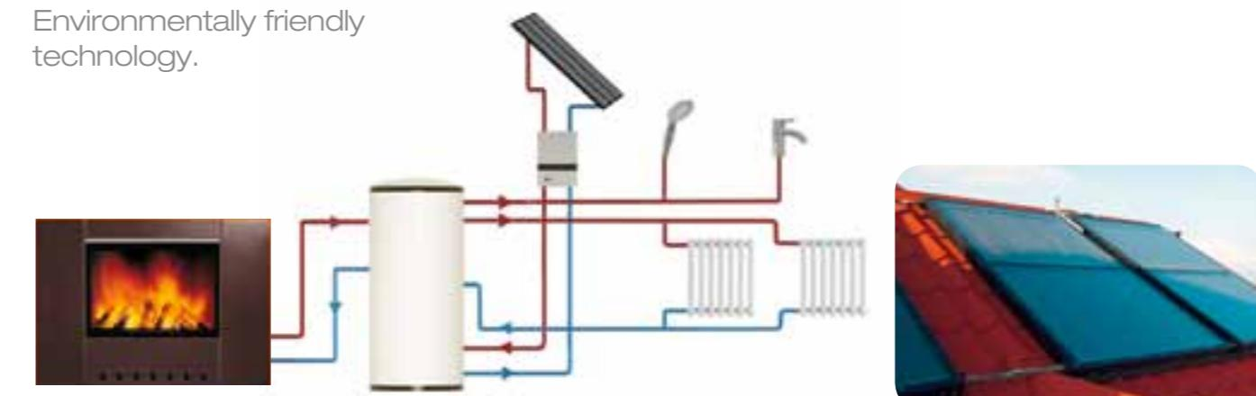
Esempio di sistema con kit solare per la produzione di acqua calda per l'impianto di riscaldamento tradizionale e acqua calda sanitaria
