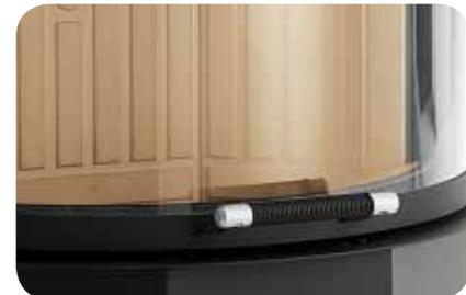
Sulla serie HT l'anta saliscendi, montata su guide flottanti, rientra di alcuni millimetri in fase di chiusura e aderisce perfettamente alla guarnizione, ottenendo così una tenuta ermetica. Il contrappeso con cavi in acciaio, rende l'apertura scorrevole, morbida e silenziosa. Il vetro è protetto da una struttura chiusa in acciaio che evita fuoruscite dei fumi durante l'apertura e la chiusura ed è apribile anche ad anta per una facile manutenzione e pulizia.
