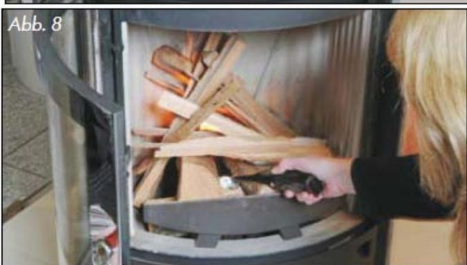
Дайте прогореть этой закладке дров с подачей первичного и вторичного воздуха, установленной на максимум ("MAX"), пока пламя почти не исчезнет, и дрова не перейдут в фазу накала (рис. 9).
