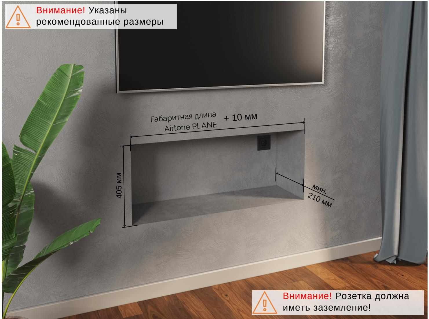
Устройство может быть встроено в нишу в стене, подвешено на стену, а также смонтировано в мебельные элементы.
