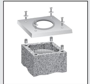
44 Подготовьте цементную подушку для установки покрывной плиты, установите покрывную плиту, зафиксируйте винтами.
